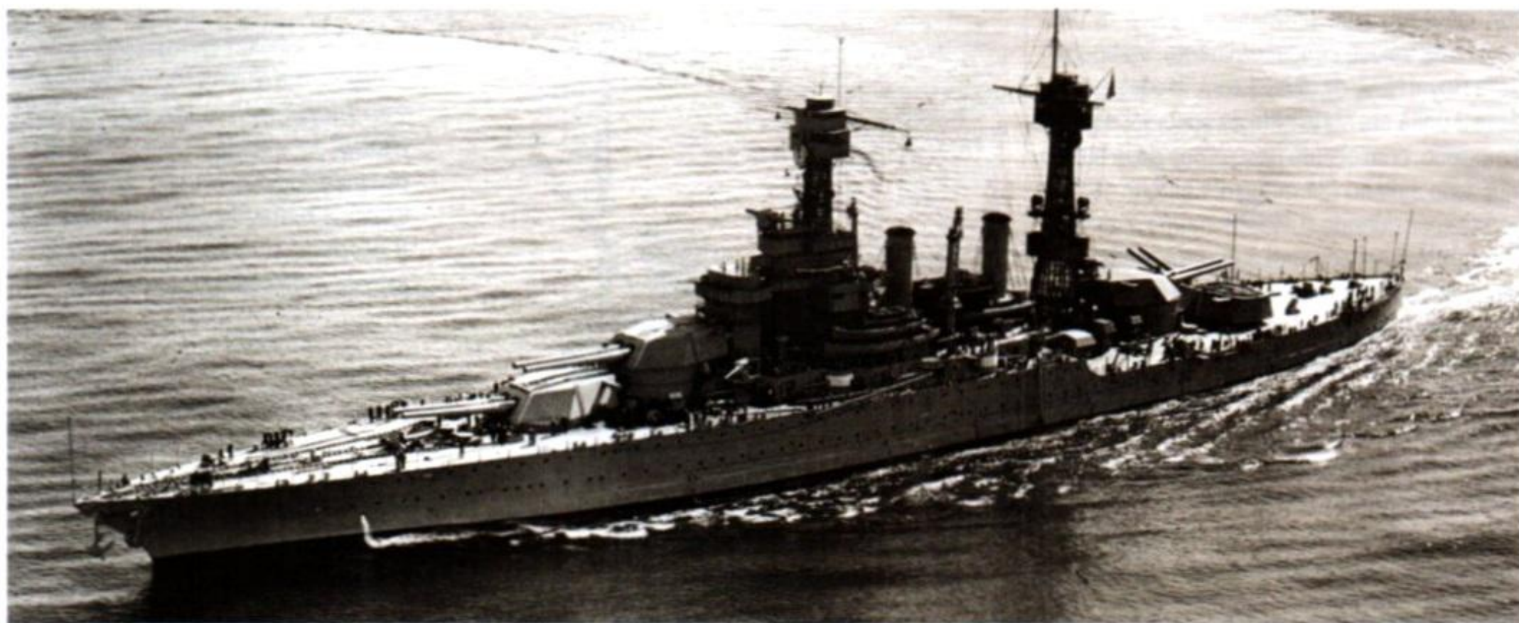
La corazzata statunitense COLORADO, una delle unità realizzate in base al programma navale autorizzato dal Congresso nel 1916, armata con 8 cannoni da 16 pollici (406 mm) in 4 torri binate.
