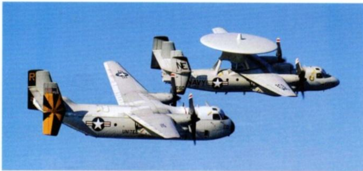
Un C-2A del VRC-30 in formazione con un E-2C del VAW-116 della USS ABRAHAM LINCOLN (CVN-72) nel 2005. Sono evidenti ali, motori ed impennaggi uguali, con questi ultimi privi di diedro sul COD. (foto: US Navy)
