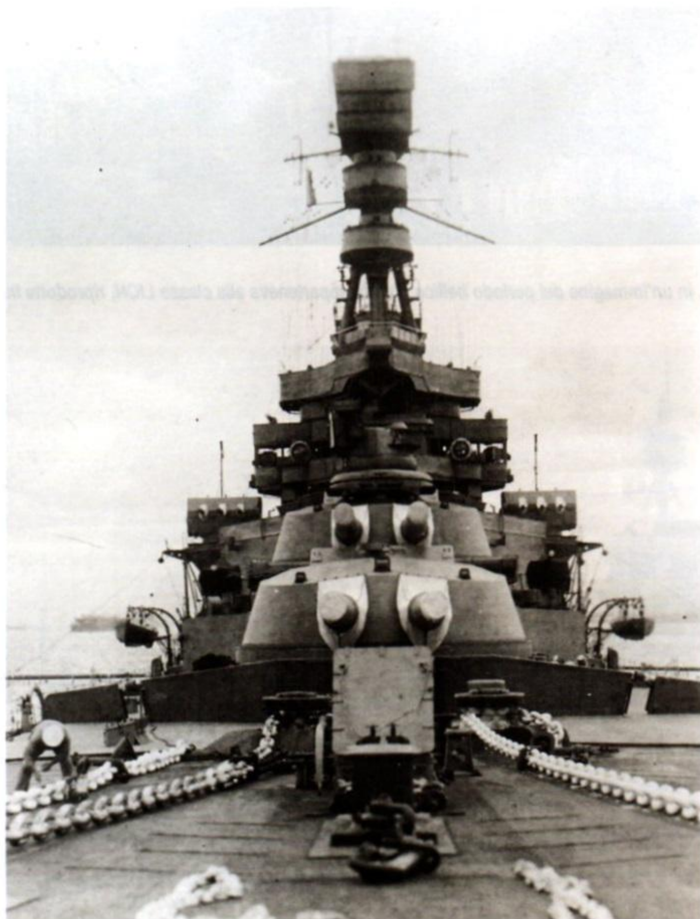
Le 2 torri prodire sovrapposte dell'incrociatore da battaglia REPULSE, in servizio dall'agosto 1916: ogni torre era dotata di 2 cannoni da 15 pollici (381 mm).
