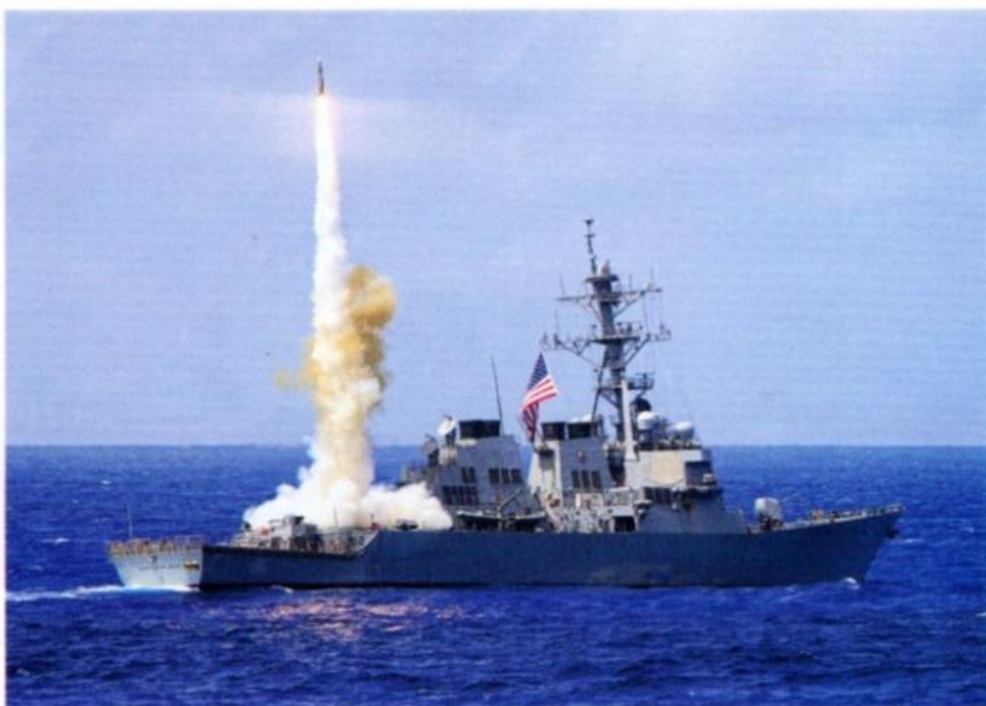
Il cacciatorpediniere CURTIS WILBUR (DDG-54), classe BURKE, lancia un missile superficie-aria SM-2 nel corso di un'esercitazione.
