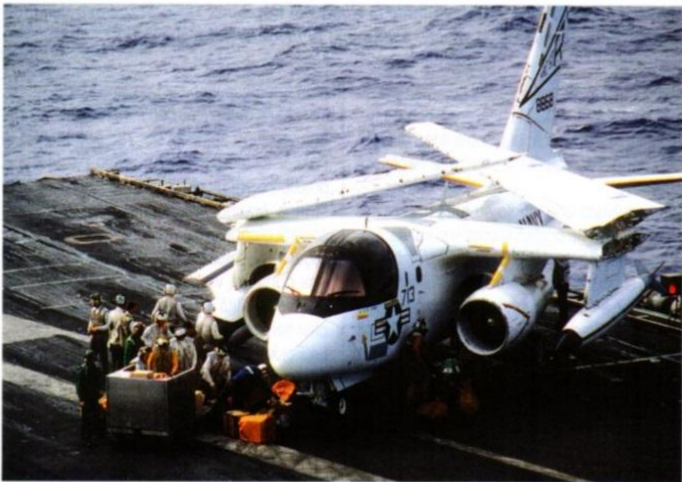
Sopra: solo 7 VIKING furono trasformati in US-3A per essere usati fino ai primi anni '90 per il trasporto urgente di personale e di piccoli colli. Sul ponte della USS ABRAHAM LINCOLN (CVN-72) si provvede a scaricare quanto contenuto nello speciale contenitore subalare. Al pilone opposto, il velivolo monta un normale serbatoio ausiliario. (foto: US Navy). Sotto: il Fokker F.28 (in un'immagine pittorica) era il velivolo che più si avvicinava ai requisiti COD dell'US Navy che lo valutò anche a NAS Sigonella. (foto: Fokker)
