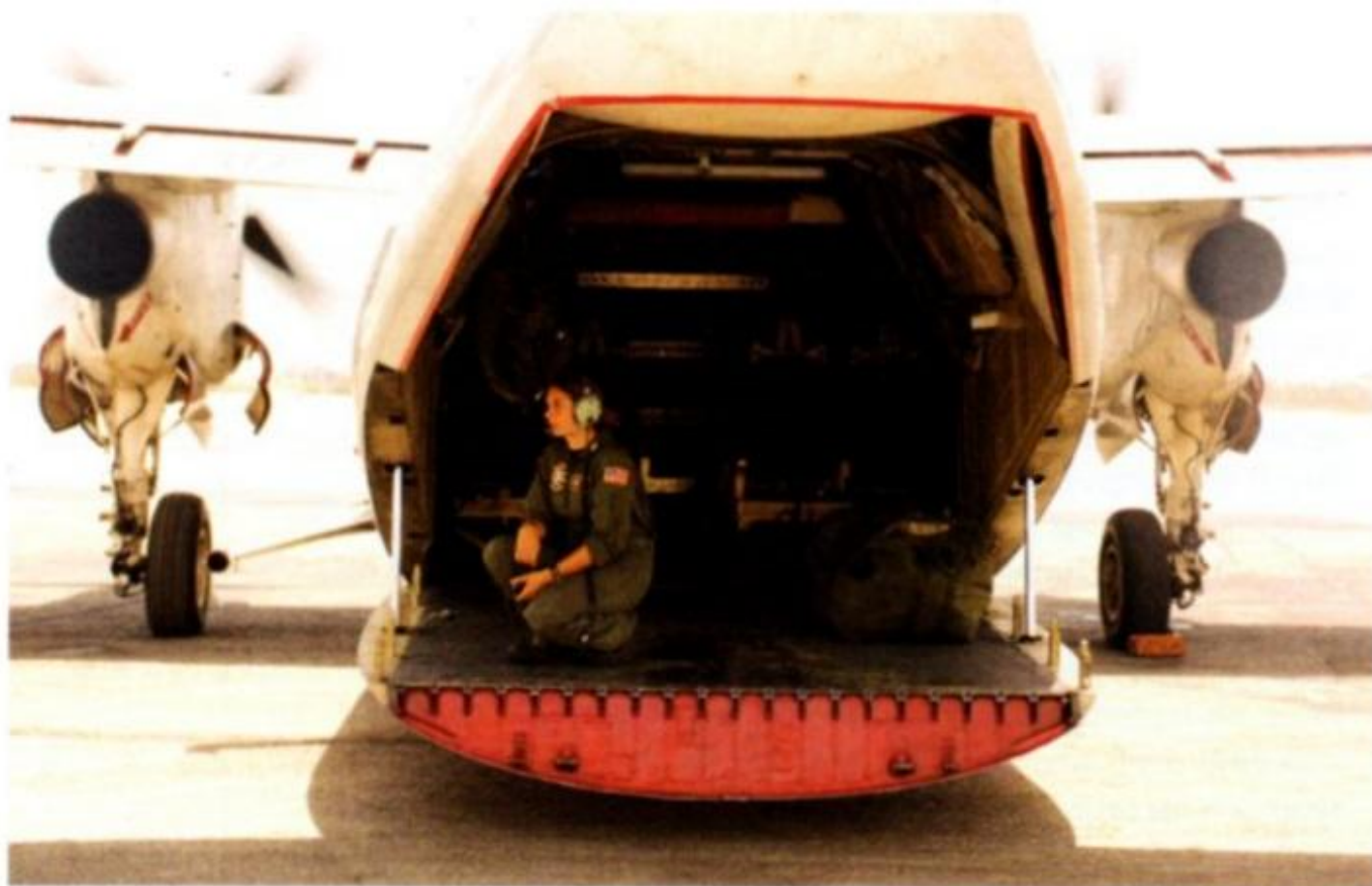
Un C-2A del VRC-30 esibisce il portellone posteriore che permette l'accesso all'ampio compartimento di carico. (foto: US Navy)
