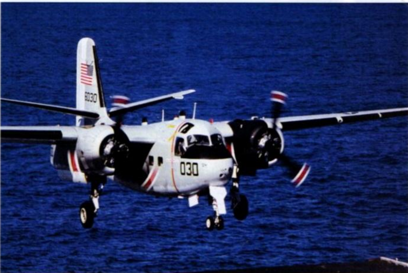
Un C-1A in appontaggio su una portaerei americana. Da notare il portello di emergenza sul soffitto della cabina di pilotaggio che normalmente veniva tenuto aperto in decollo e in appontaggio per facilitare l'abbandono del velivolo in caso di incidente.
