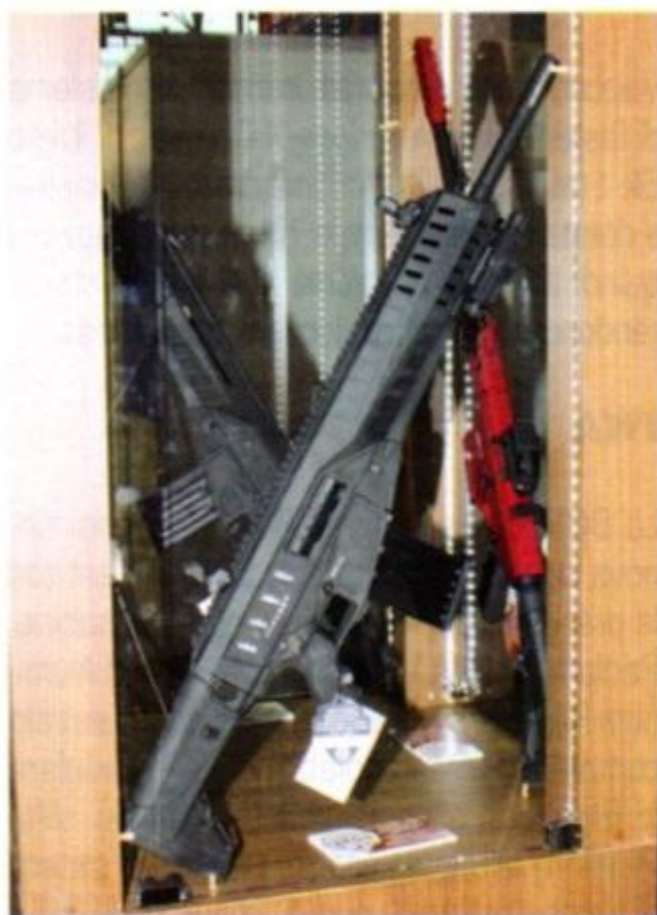
Sopra: l'Uzkon TYPHOON ARS 12 calibro 12/76: nonostante le apparenze da Assault Rifle è un'arma a canna liscia semiautomatica. Utilizza scocca polimerica ma con carcassa interna in alluminio. Sotto: versione PDW con canna da 221 mm per la B&T APC-556 calibro 5,56x45, dotata di nuova calciatura compatta a stampella che limita ulteriormente pesi ed ingombri per l'uso.
