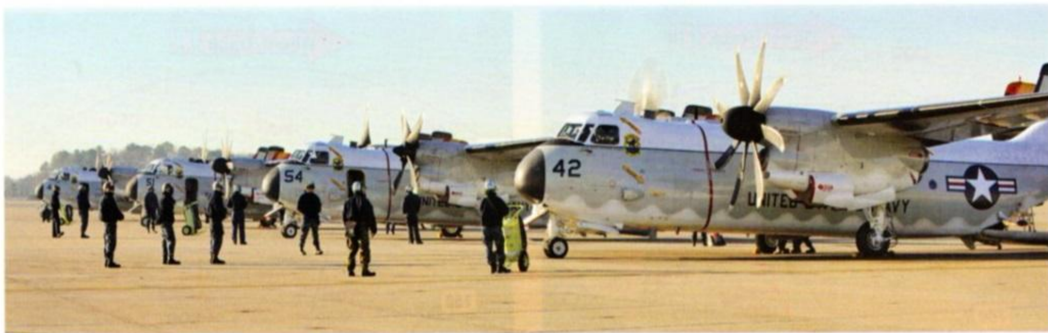
Schieramento dei C-2A del VRC-40 nel gennaio 2010; dei 4 esemplari mostrati, uno solo monta ancora le vecchie eliche quadripala mentre gli altri hanno ricevuto le nuove Hamilton Sundstrand NP2000 a 8 pale. (foto: US Navy)
